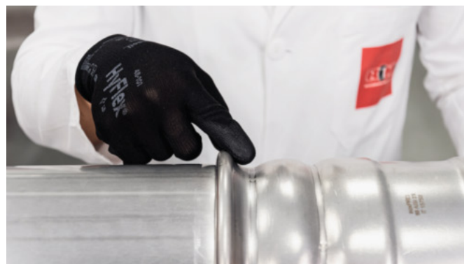
Bild 36 – Sichtkontrolle beim Verpressen von Übergrößen
