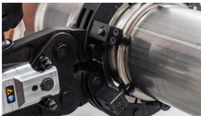
Figure 35 - Assemblage de la chaîne phase 2
