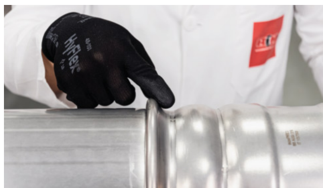
Figure 36 - Inspection visuelle du sertissage Oversize
